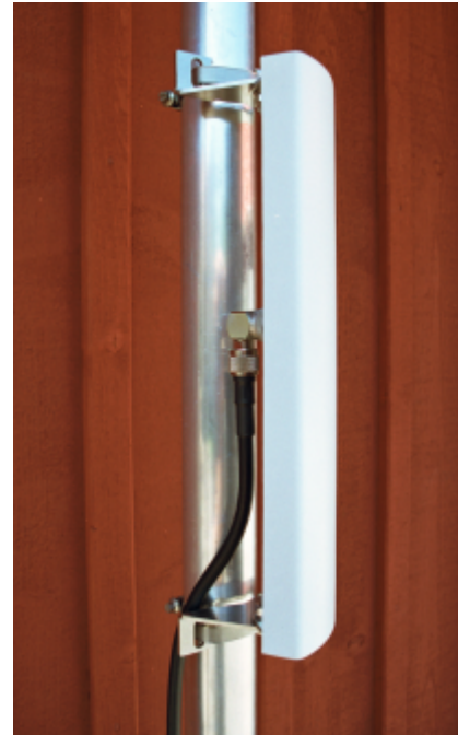
Panelantenn 5.47 GHz med 4 / 6 element, 14 - 15.5 dBi gain.
